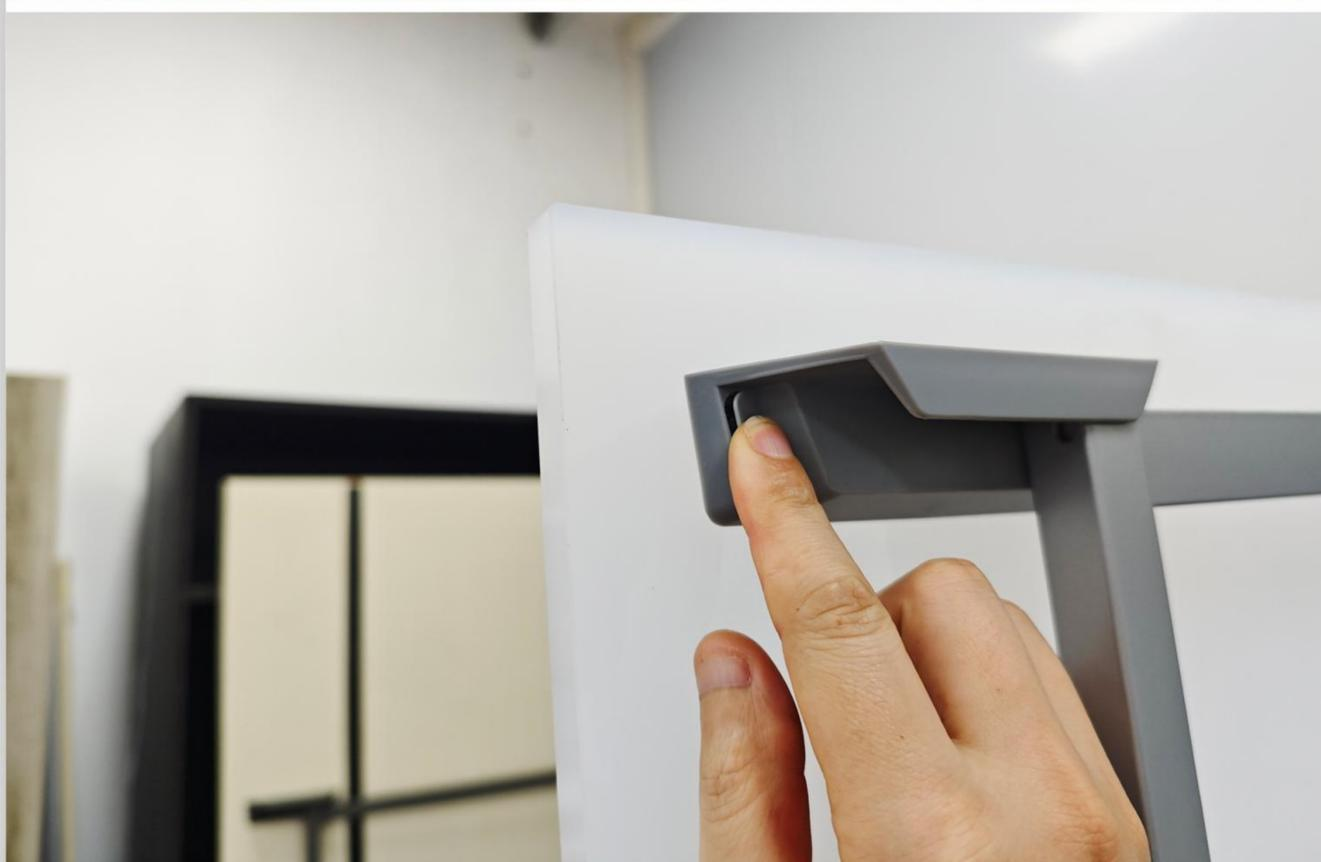
门板框架滑槽对准预钻孔，自攻螺钉锁紧，再安装螺钉孔装饰盖，对准凹槽按压即可（下/上）。
