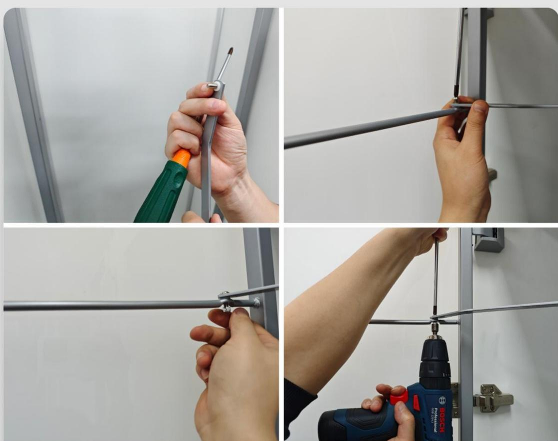
连接杆、塑料垫圈穿入螺钉，上端连动杆
