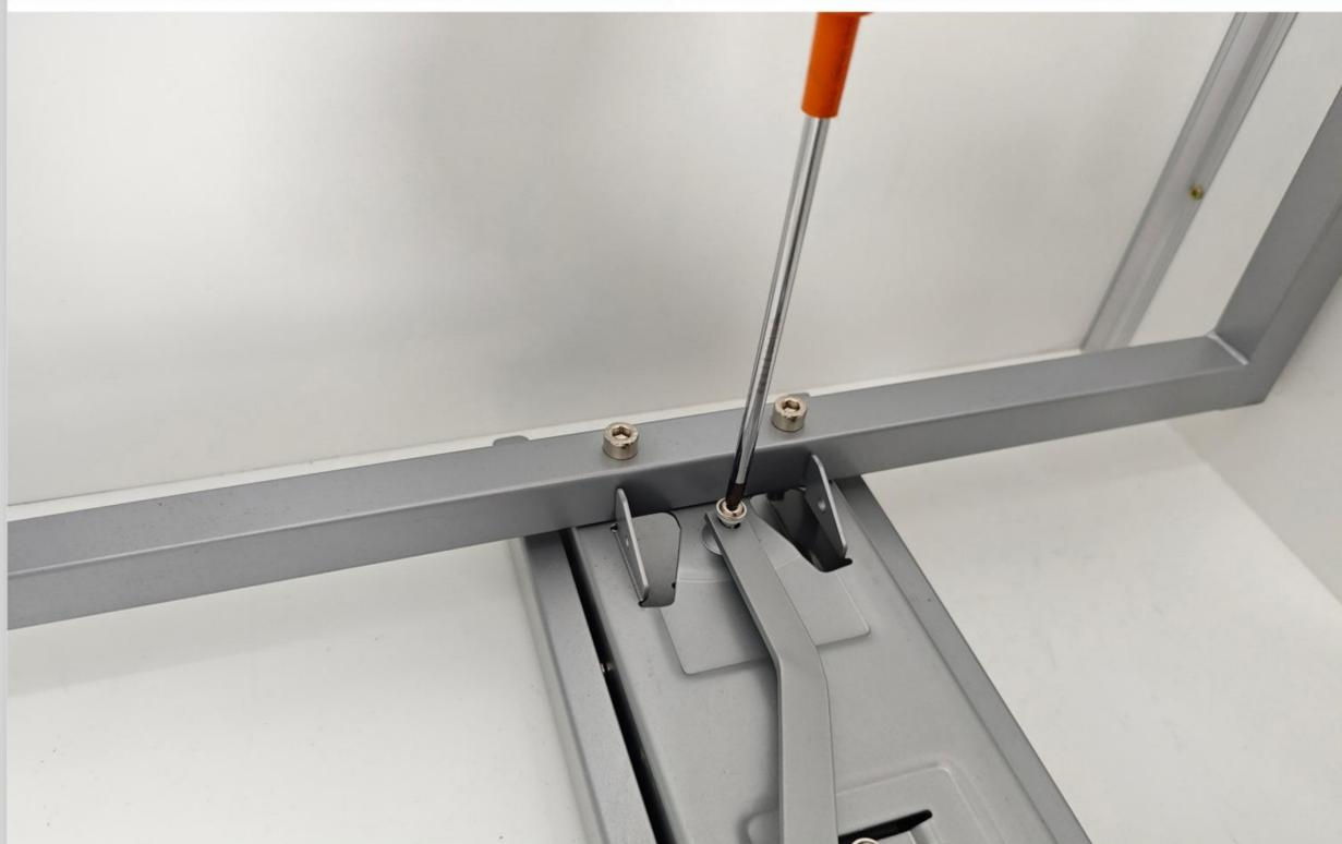
连接杆、塑料垫圈穿入螺钉，连动杆对准大导轨内轨固定处，锁紧螺钉。
