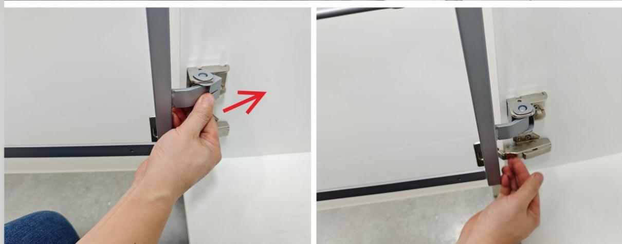
门板框架对准上下滑槽推入，门板框转动轴对准转动底座卡入，按压门板塑料转动件，翻转固定（下/上）。
