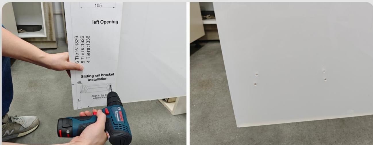
使用安装模版对门板下端预钻孔。
